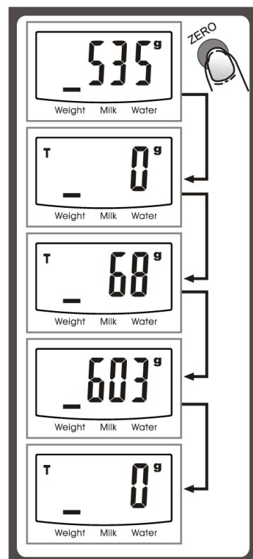
Bu fonksiyonda iken; ZERO düğmesine basarak tartılan tüm malzemenin toplam ağırlığını görebilirsiniz. Eğer daha fazla malzeme daha tarmak isterseniz; ZERO düğmesine basarak LCD ekranı “0” gözükene kadar resetleyiniz.
